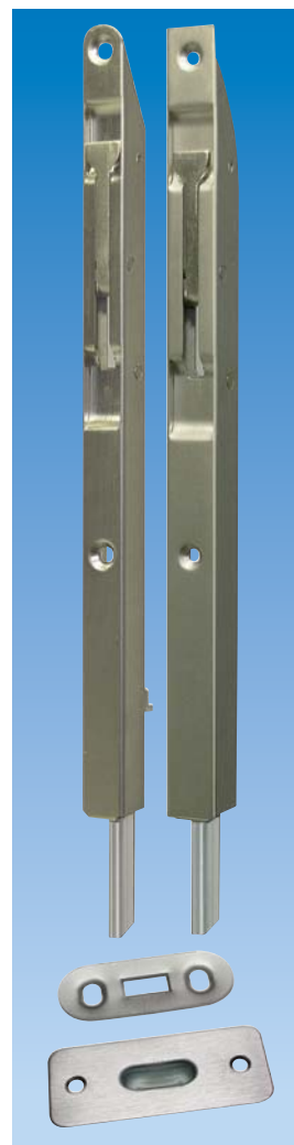
Planet KR Kantriegel, inkl. Schliessblech Option: Bodenmulde 5×13 mm schmal
